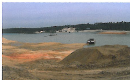
8. Pískovna Cep II je jedním z významných, v současné době těžených ložisek štěrkopísku na území CHKO. Těží se povrchově z vody. Na bázi ložiska jsou pestrobarevné jíly, jílovce a kaolinitické pískovce klikovského souvrství. Při rekultivaci se uplatňují způsoby obnovy blízké přírodním procesům.
